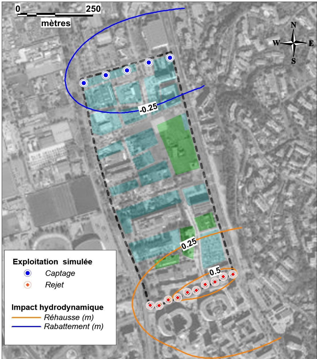
Figure 67 : Impact hydrodynamique sur la nappe du Var pour la simulation 4 (source : ANTEA, 2017)
