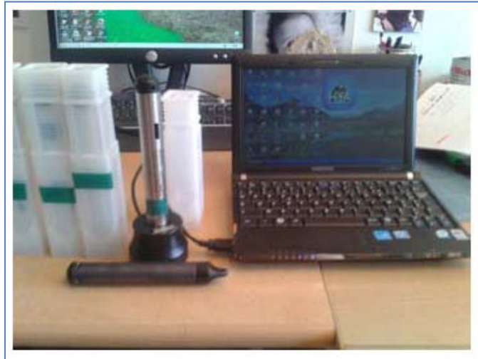
Sonde autonome de niveau/conductivité/température
