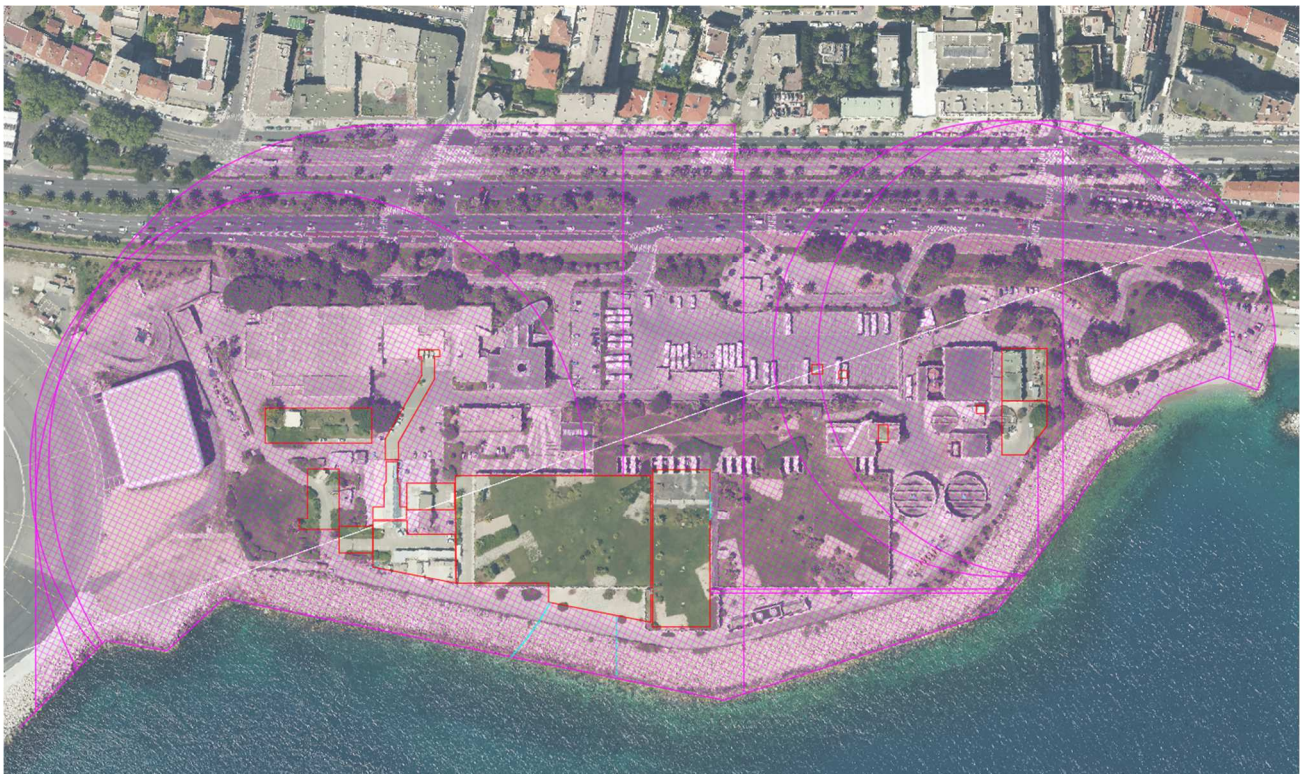
Zone d'alimentation des pompages durant les phases de terrassements / construction
