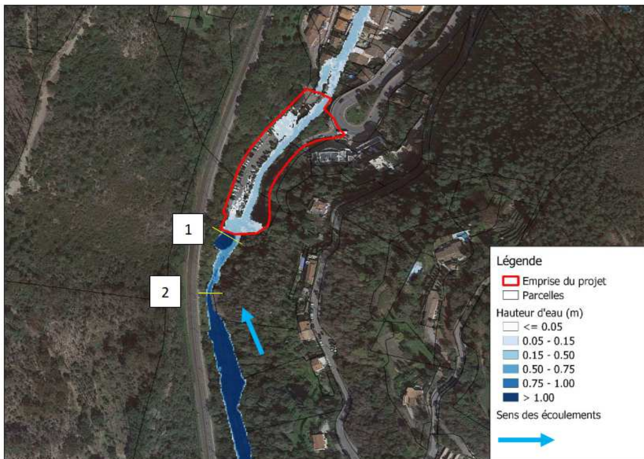
Illustration 18 : Hauteurs d'eau maximales modélisées pour une crue centennale augmentée de 20% en situation existante
