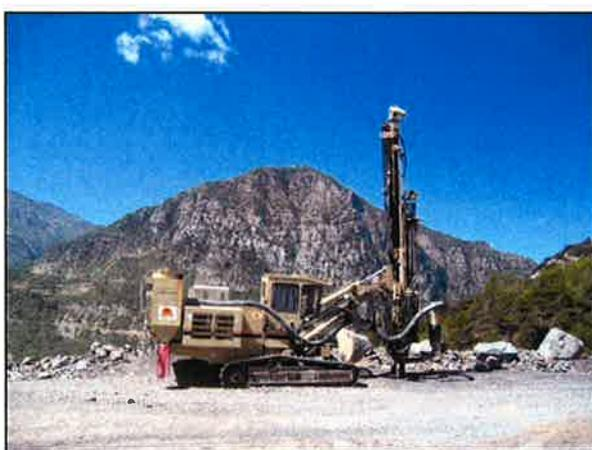
*Foreuse sur chenilles permettant le forage des trous de mine*
