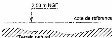
Pour les vallons dont la cote de crue n'est pas rattachée au nivellement général de la France (NGF), la cote de référence est celle du niveau du terrain naturel existant augmentée de un mètre.
