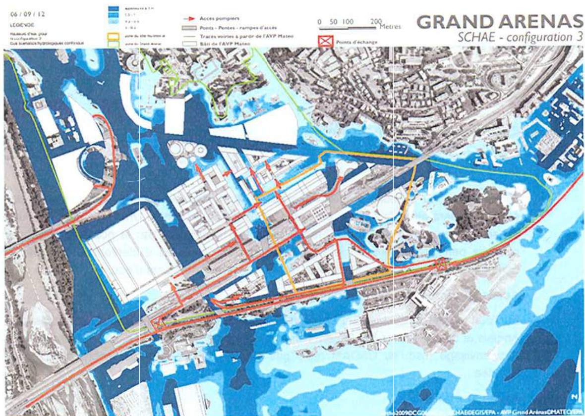
Figure 18 : Schéma fonctionnel des accès au secours en cas de crise
