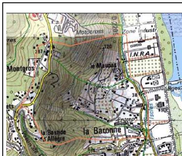
Les deux vallons sont enterrés pour le passage des zones urbaines peu denses du coteau et se jette dans le canal des Iscles en aval de la RD1. Le canal est aménagé en un trapèze de 3 m de base, le fruit des berges est de 1/1. La capacité du vallon est suffisante pour faire passer le débit centennal du vallon.
