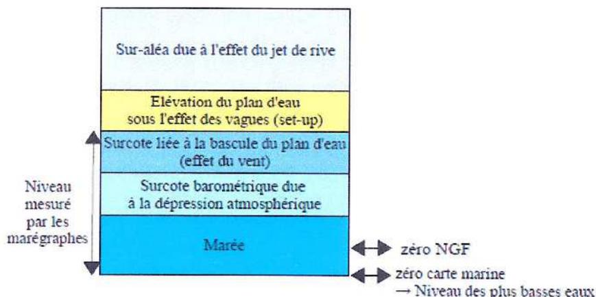
La détermination de l'aléa de submersion marine repose sur l'identification des composantes suivantes :
