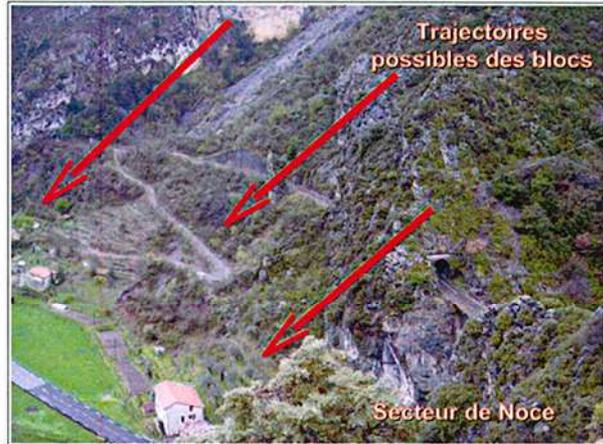
L'encaissement de la vallée de la ROYA amène à la classer presque intégralement en aléa élevé, moyen et faible de chute de blocs.
