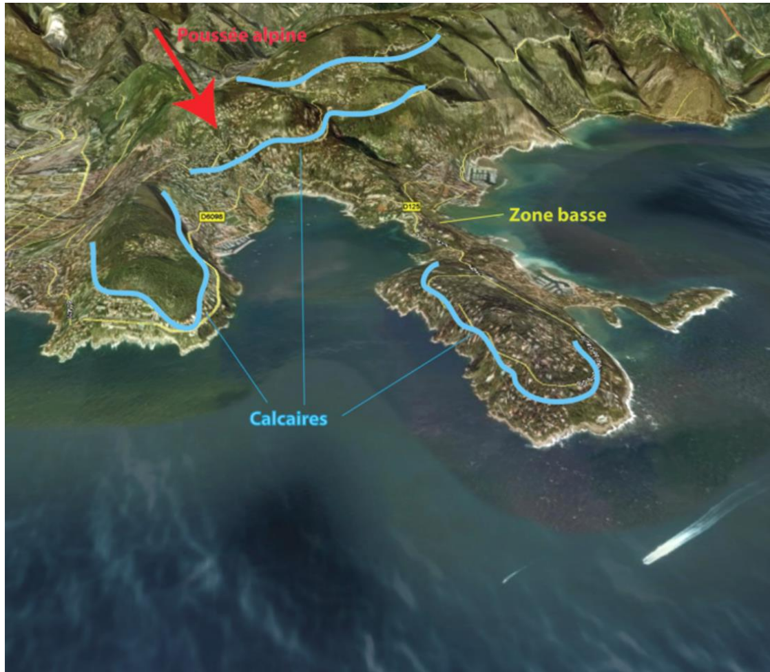
Figure 32: les principales barres calcaires du Secondaire qui surplombent les corniches et le cap Ferrat (bleu). La flèche rouge indique le sens de la poussée alpine.
