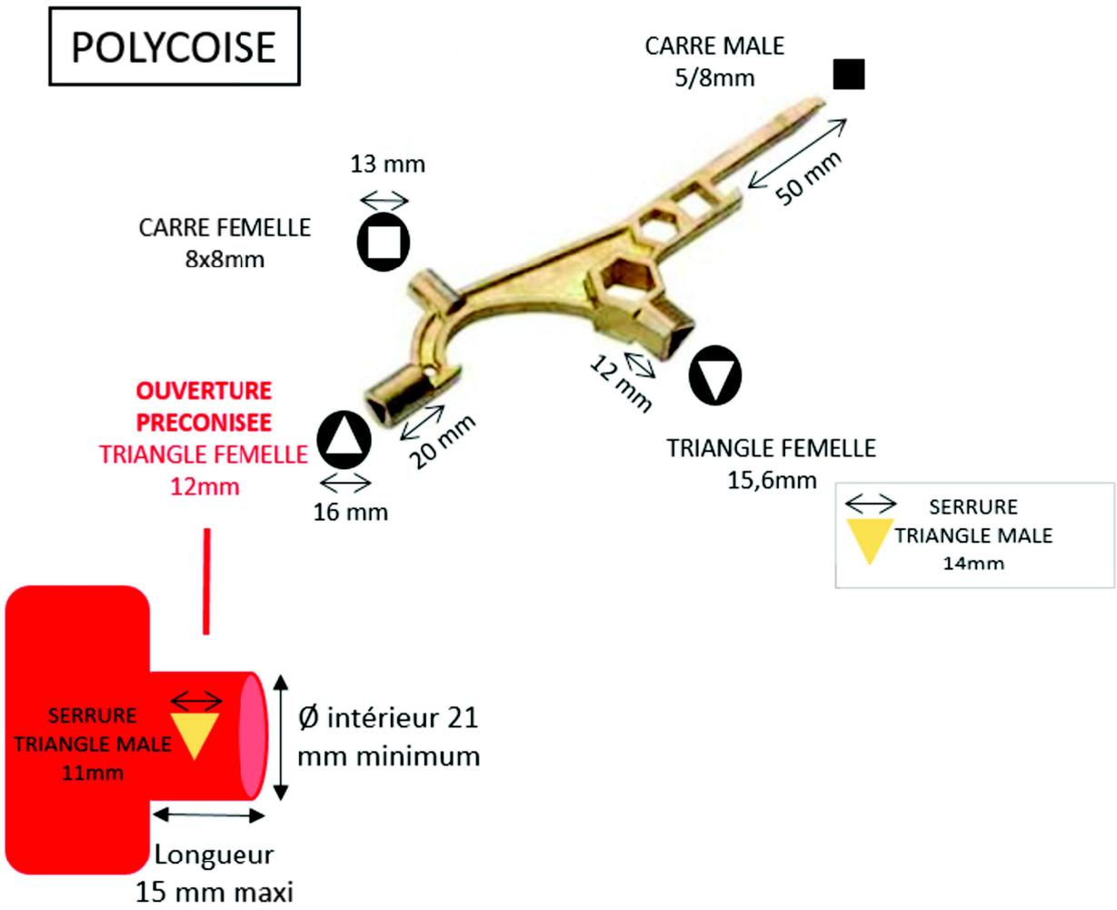
Figure 3. Caractéristiques de la clé polycoise multifonctions (Source : SDIS06)
