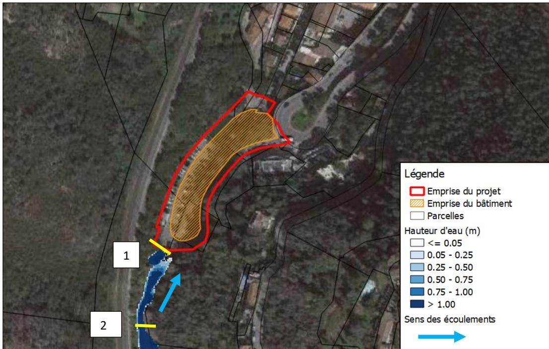
Illustration 170 : Hauteurs d'eau maximales modélisées pour une crue centennale avec la buse en amont bouchée en situation projetée
